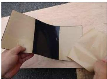
離型紙中央部の任意の2カ所にカッターでスリットを入れて離型紙を剥がします。
